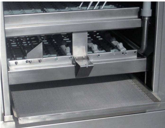
Die mehrfache Flächensiebtechnik gewährleistet, dass der Tankraum nicht von mechanischen Teilen verunreinigt wird, die dann in das Waschsystem gelangen und Schäden an der Waschpumpe oder den Leitungen verursachen könnten.
