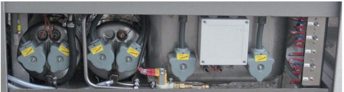
Die Waschpumpe saugt seitlich am Waschtank die Lauge an und fördert diese in das Waschsystem.
