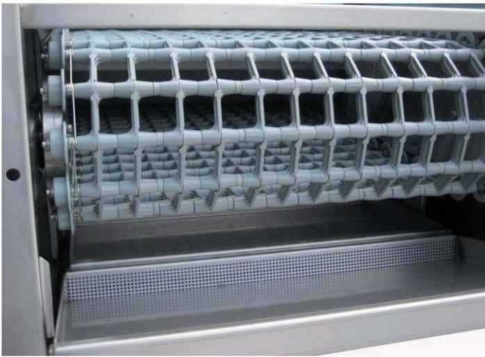
Unter dem Band des Zulaufbereiches befinden sich 2 Kassettenfilter die verhindern, dass beim Bestücken des Bandes Verunreinigungen fester Art in den Tankraum gelangen.
